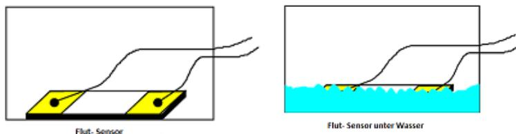
Wenn die Flut-Sensoren feucht werden oder unter Wasser steht, löst die Elektronik Alarm aus.
